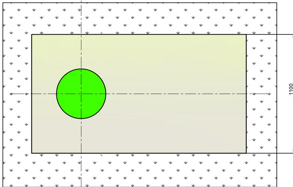
1. Корпус изделия выполнен из прочного пластика - полипропилена с рёбрами жёсткости. Ёмкость предназначена для наземной установки на специальные опорные подставки, благодаря которым обеспечивается особая устойчивость и надёжность в эксплуатации.
