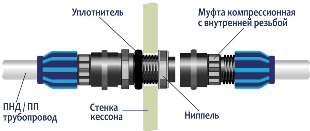
Рисунок 12. Монтаж ПНД/ПП трубопровода в пластиковый кессон
